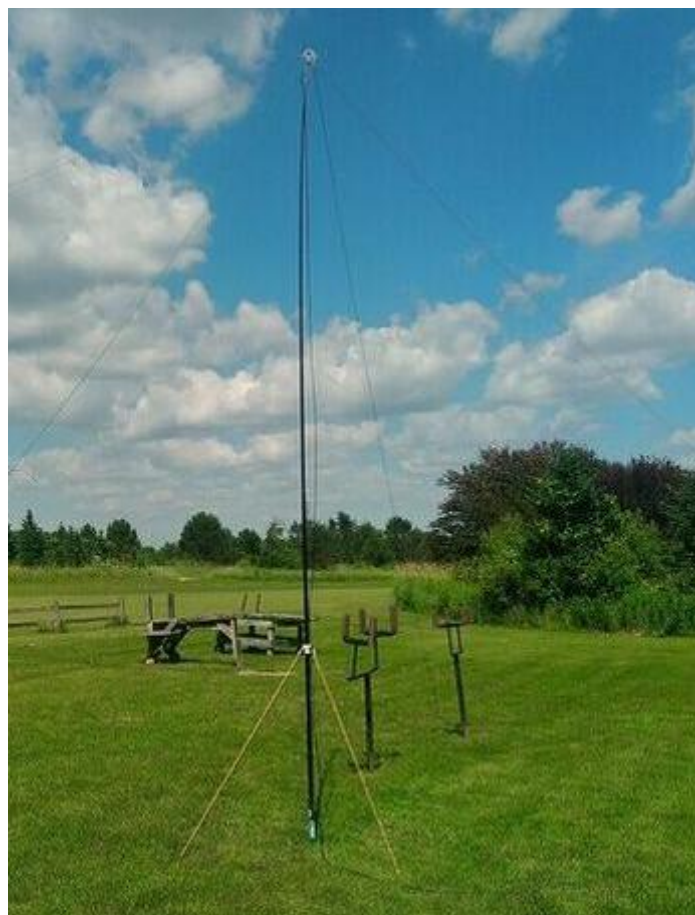
Mástil fibra de carbono telescópico.
