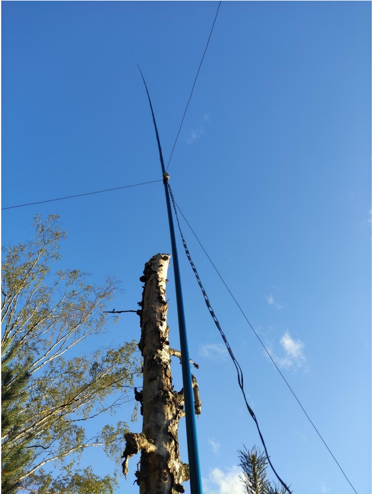
Antena multibanda ZS6BKW montada sobre mástil telescópico de fibra de carbono.
