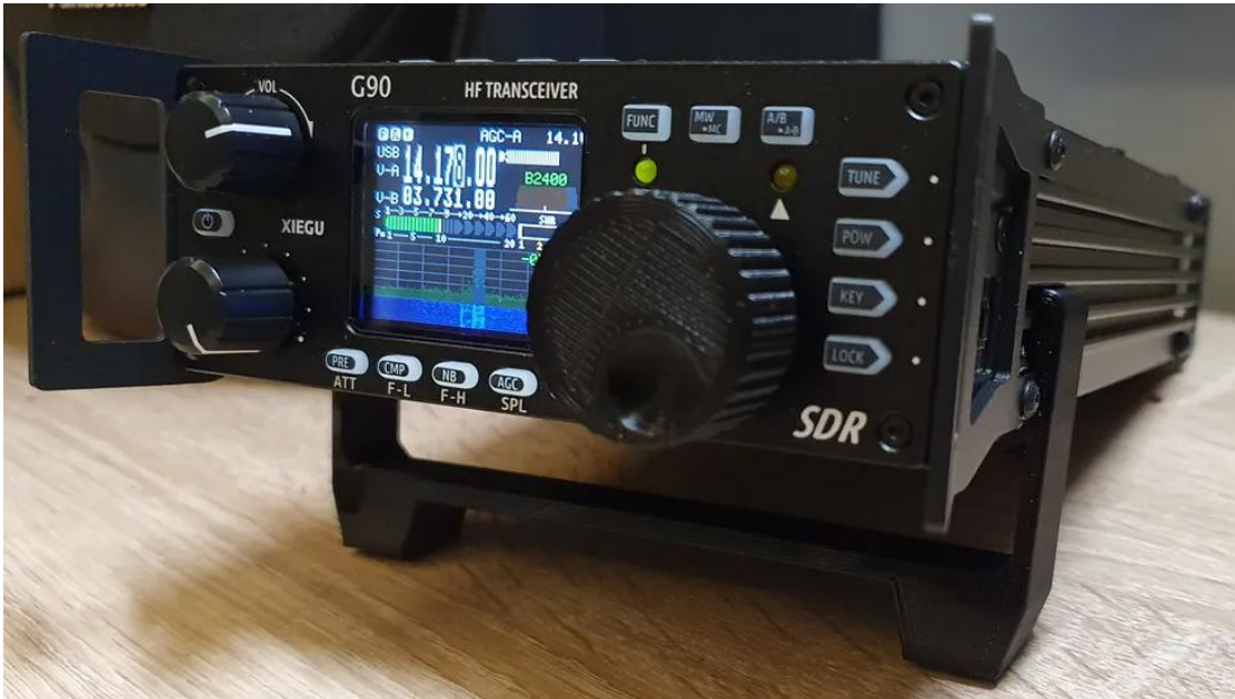
Transceptor XIEGU G90 - Bandas 80 -10 m - Todo modo - Potencia 1 a 20 W - Tuner interno.
