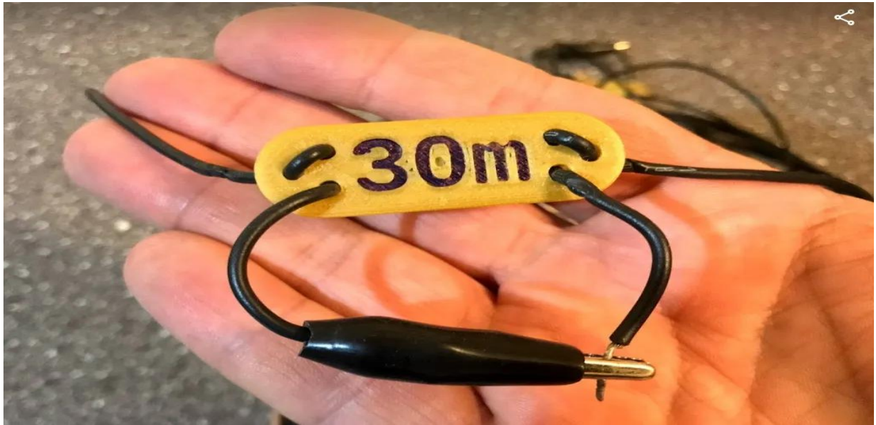
Modelo de aislador y conexionado en cada tramo de la antena.
