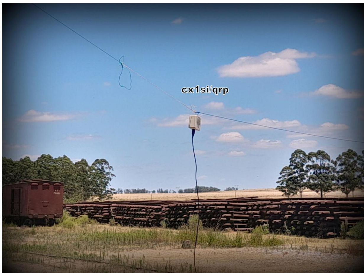
Antena End Fed con transformador adaptador de impedancia 49:1
